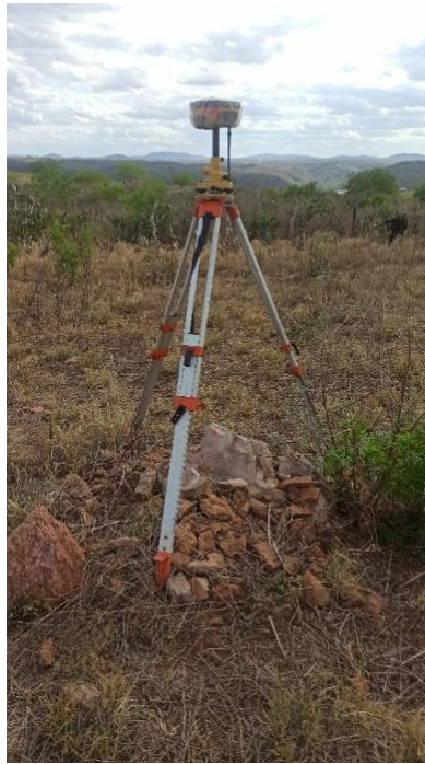
Figura 5. Base GNSS RTK em solo.
