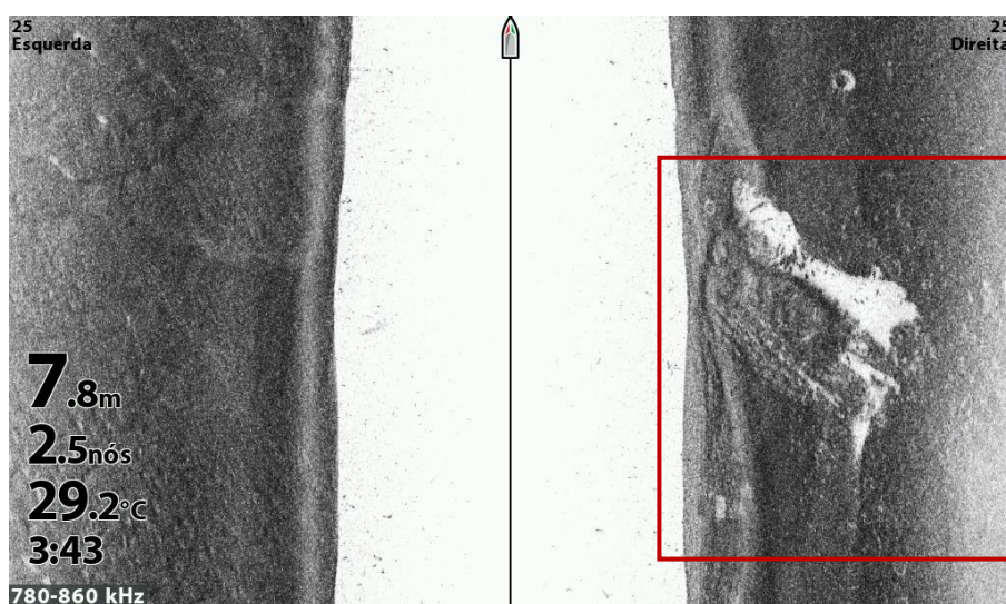
Figura 8: Registro acústico da área da balsa de madeira soçobrada (vermelho). Fonte: idem.
