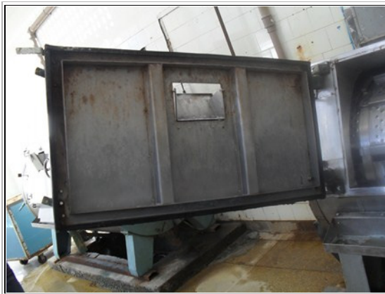
Maquina de lavar com pontos de ferrugem
