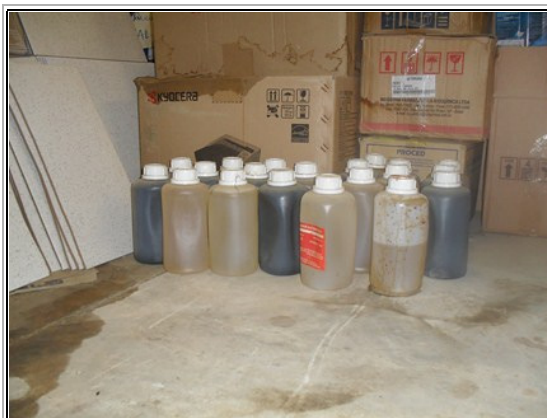
Material sem identificação adequada colocado sob o chão sujo
