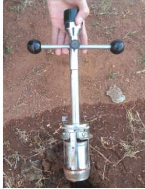
Figura 2: Amostrador tipo Uhland para realização de coleta das amostras de solo em campo.
